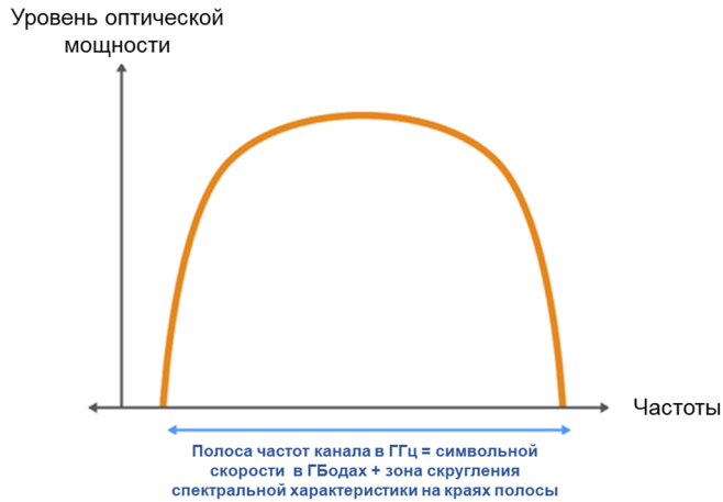
Рис. 2. Ширина спектра канала пропорциональна символьной скорости передачи [14]
