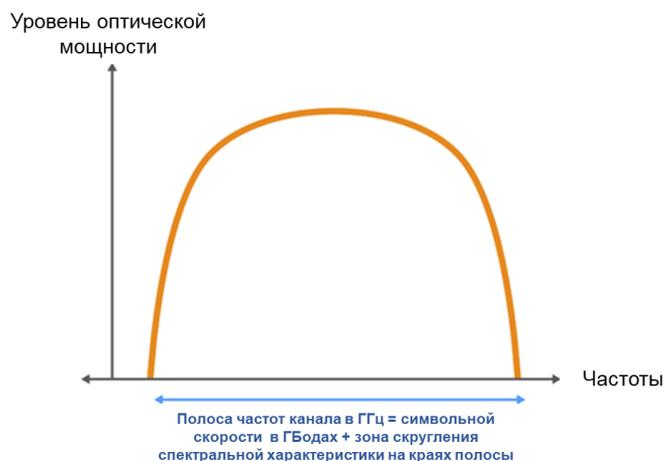
Рис. 2. Ширина спектра канала пропорциональна символьной скорости передачи [14]
