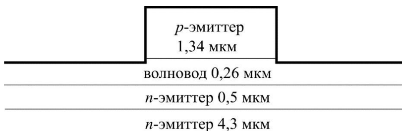
Рис. 1. Латеральный 2D-волновод мезаполосковой конструкции
