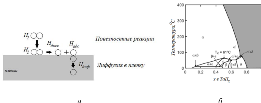
Рис. 2. Стадии реакции между молекулами газообразного водорода и поверхностью пленки Та (а). Диаграмма состояния системы Та–Н 2 (б) [13]
