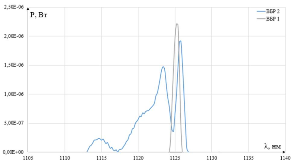
Рис. 5. Спектры пропускания для двух ВБР
