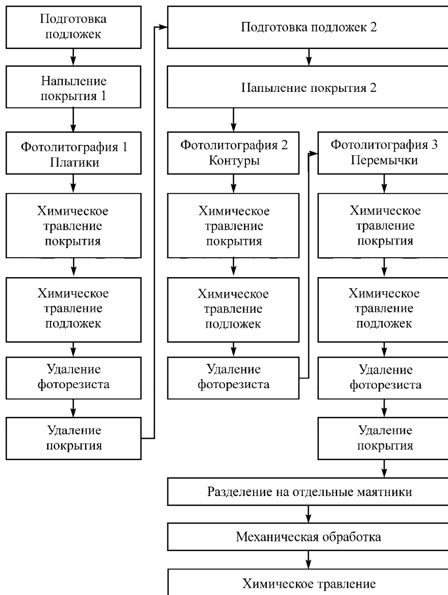
Рис. 5. Схема группового технологического маршрута изготовления маятников из кварцевого стекла
