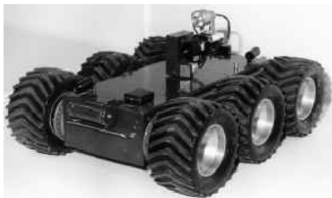
Рис. 7. Вариант самоходной платформы (робот) для прокладки оптических кабелей
