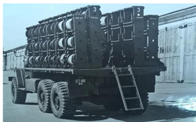
Рис. 2. Кабелеукладчик внутриузлового кабеля
