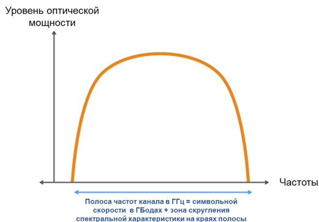
Рис. 2. Ширина спектра канала пропорциональна символьной скорости передачи [14]
