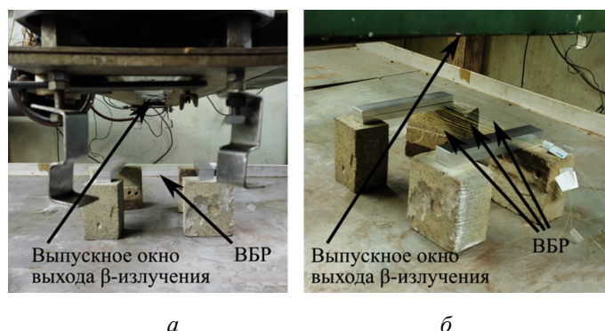
Рис. 2. Схема расположения ВБР в процессе воздействия \beta -излучения: вид сбоку (а), вид спереди (б)
