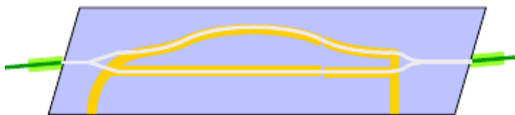
Рис. 6. Модулятор IMZI с высокой разностью хода между двумя плечами [13]
